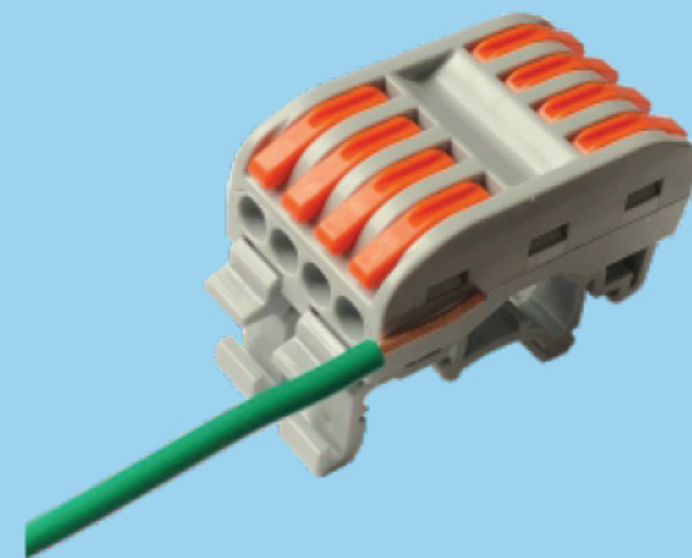
第一步 First Step 按标定长度剥去导线外皮。 strip the wire 11-12mm
